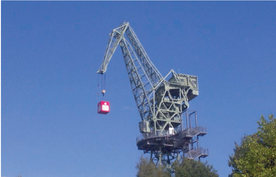
Figuur 5 ‘Der Eber’ in Eberswalde: Dit Doppellenkersystem für Drehkrane werd 1932 aldaar door de Ardelts-Werke uitgevonden.
