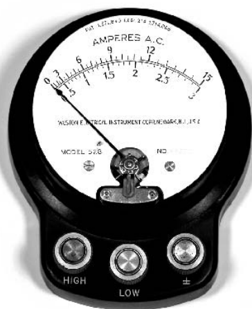
Figuur 1 Voor het tekenen van schalen op meetinstrumenten zoals ampèremeters is soms trisectie van hoeken nodig om te interpoleren tussen grote waarden. De trisectiemethode van de auteur bestond uit het spannen van een koord over de hoek en die in drie gelijke stukken delen. Het resultaat is een benadering die goed is voor kleine hoeken maar duidelijk slecht voor grotere hoeken. In het plaatje rechts is het resultaat grijs, terwijl de correcte hoeken met kleine streepjes op de boog aangegeven zijn. De meter links is uit de tijd dat de auteur zijn trisecties uitvoerde, maar is niet door de auteur gedaan. Het vertoont tekenen van een meer geavanceerd algoritme.
