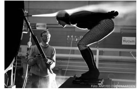
Figuur 7 De Poolse Pavel Zygmunt in de windtunnel tijdens proeven aan een pak met driehoekige applicaties en verschillende stoffen op armen en benen
