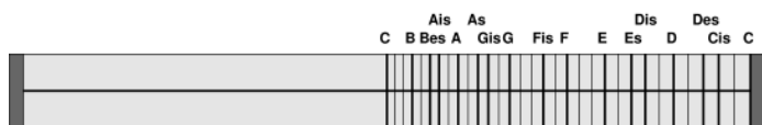
Figuur 14 Een monochord met een evenredigzwevende 31-toonsverdeling van het octaaf C–C. Het klinkende deel van de snaar bevindt zich links van de verplaatsbare kam. De dwarslijnen die horen bij de (benaderde) middentoonstemming (zie de kolommen IV en V in figuur 15) zijn dik getekend.
