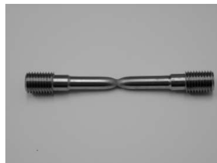
Figuur 2 Een metalen buis met een nek die ontstaan is doordat er teveel kracht op de buis stond.
