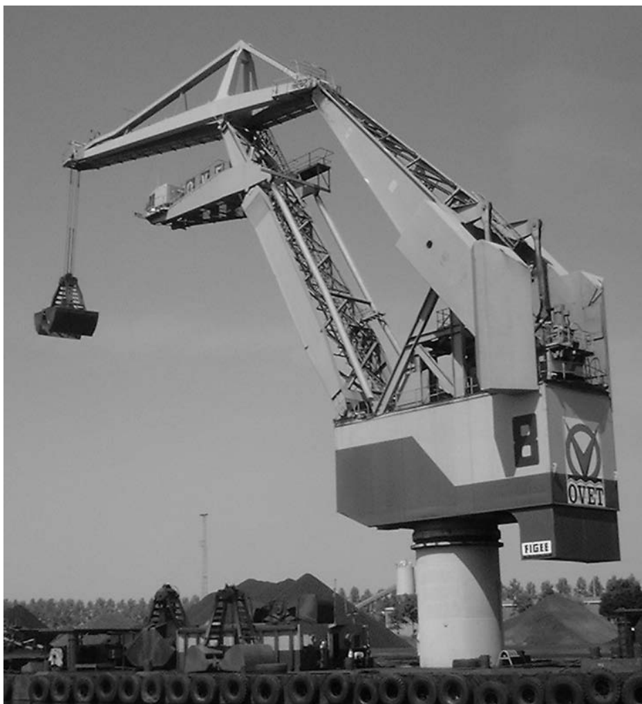
Figuur 3 De balancering van de lemniscaatkraan is in veel gevallen gezocht in de achterarm. Hier vormt de ballastbak een geheel met de achterarm.
