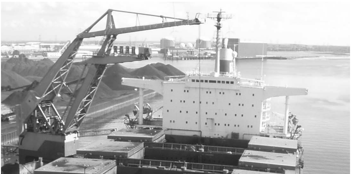
Figuur 4 De 25 tons lemniscaatkraan van OVET lost direct op de wal.
