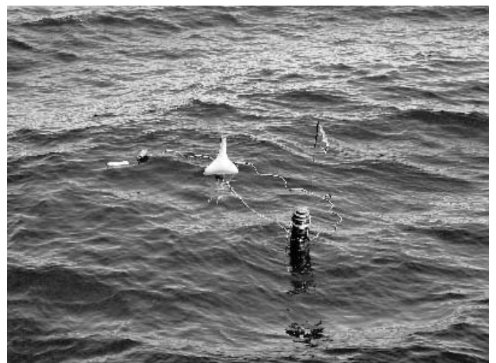
Figuur 1 Een te water gelaten boei met ontvanger voor de ontvangst van gepropageerde pulsen en een GPS antenne ten behoeve van plaatsbepaling
