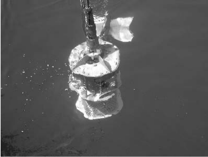
Figuur 2 De geluidsbron voor onderwater propagatie van sonar pulsen
