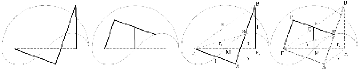
Figuur 6 Links: twee constructies van de lemniscaat als koppelkromme. Slechts de helft van de koppelkromme is hier te zien: een halve lemniscaat en een halve cirkel. Rechts: notatie bij de constructies van de lemniscaat als koppelkromme
